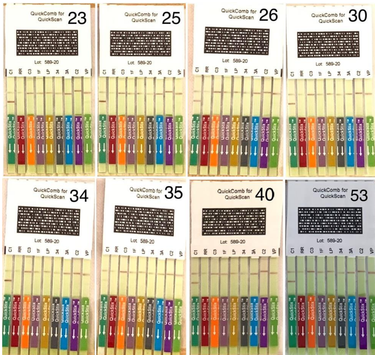
Figura 2. Resultados positivos en 8 de las 53 muestras evaluadas. La tira reactiva positiva C1 corresponde a la proteína Cry1A, que en el caso del maíz es la Cry1Ab. Los números indican el orden en el que fueron analizadas.
